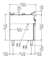
Electrical inlet (power) Equipotential screw
